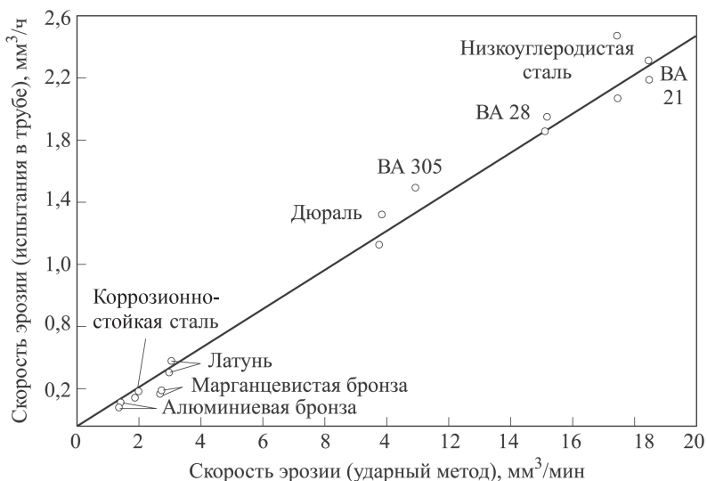
Рис. 4. Зависимость скорости эрозии при гидродинамической кавитации и от скорости эрозии при ударном методе разрушения образца
