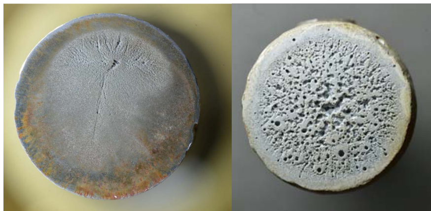
Рис. 9. Вид кавитационной эрозии на образце из стали марки Ст3 (слева) и на полимерном покрытии после 8 ч наработки
