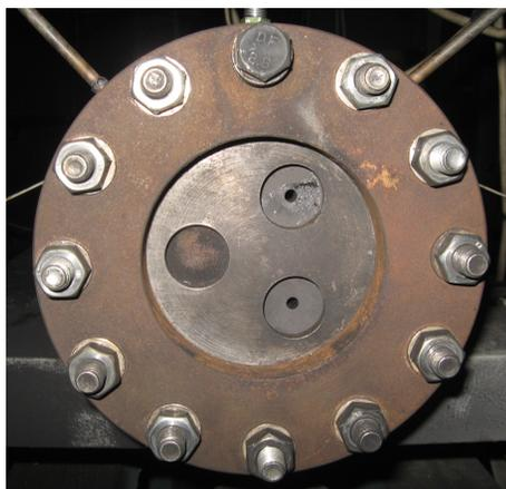
**Рис. 1.** Общий вид соплового блока модельного газогенератора
