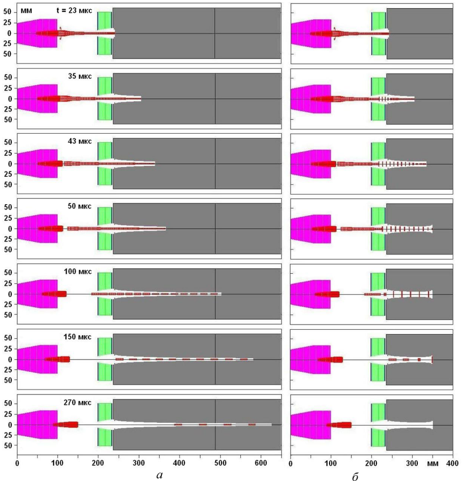
Рис. 6. Расчетные результаты действия кумулятивного заряда по стальной преграде: а — в отсутствие токового воздействия на кумулятивную струю; б — при пропускании по струе мощного импульса электрического тока
