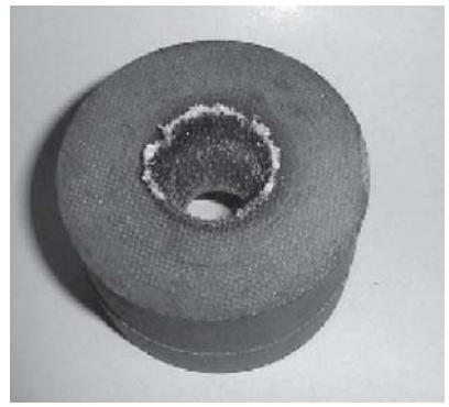
Рис. 8. Вкладыш критического сечения после огневого стендового испытания
