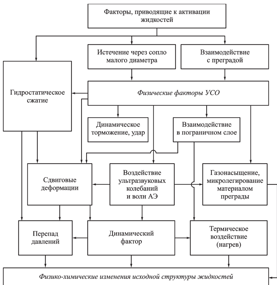
Рис. 1. Физические факторы, влияющие на ультразвуковую активацию ГТС (жидкостей)
