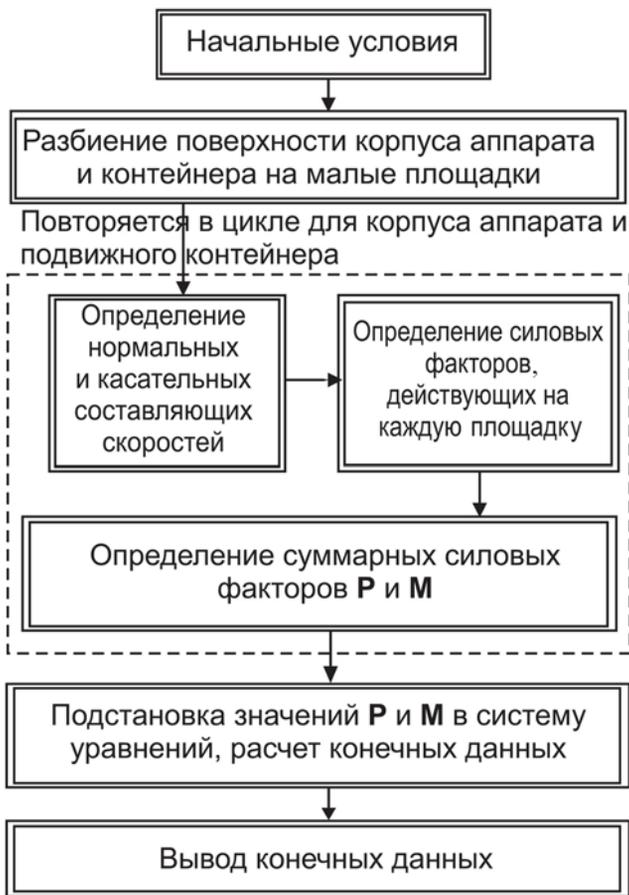
Рис. 6. Принципиальная схема решения задачи
