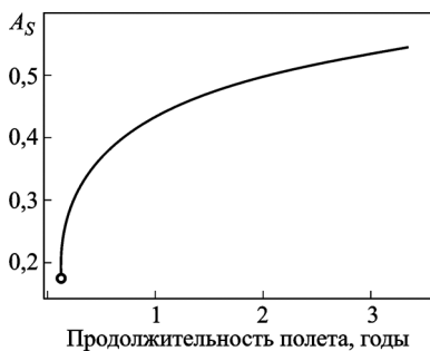
Рис. 1. Изменение коэффициента поглощения A_s покрытия на геостационарном спутнике связи
