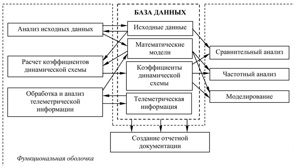
**Функционально-структурная схема программно-математического комплекса**
