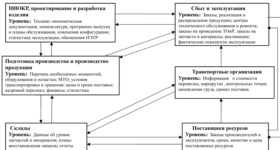
Рис. 2. Базовая схема уровней и потоков СЛП ЖЦ НП
