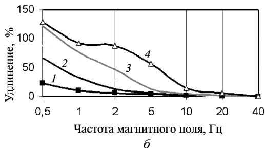
Рис. 3. Зависимость удлинения анизотропного МЭК от амплитуды (а) и частоты (б) магнитного поля для двух направлений ориентации образца:
