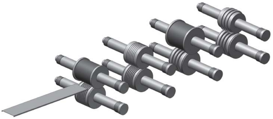
Рис. 2. Схема последовательной формовки каналов в четырех калибрах
