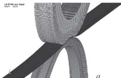
Рис. 6. Деформированная расчетная сетка (1-я клетка)
