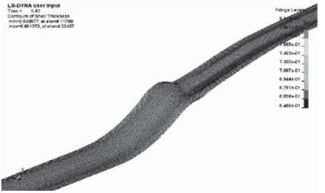
Рис. 21. Поле толщины заготовки при деформировании (третья клеть)
