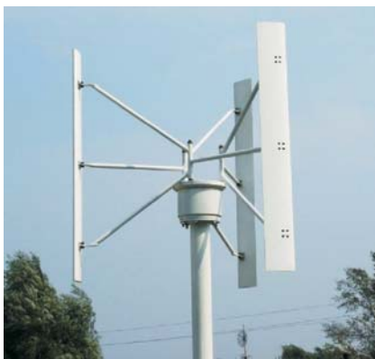
Рис. 4. Вертикально-осевая ВЭУ с ротором типа «Н-Дарье»
