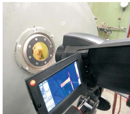
Рис. 2. Фрагмент эксперимента — термоскопия образца тепловизором через окно вакуумной камеры
