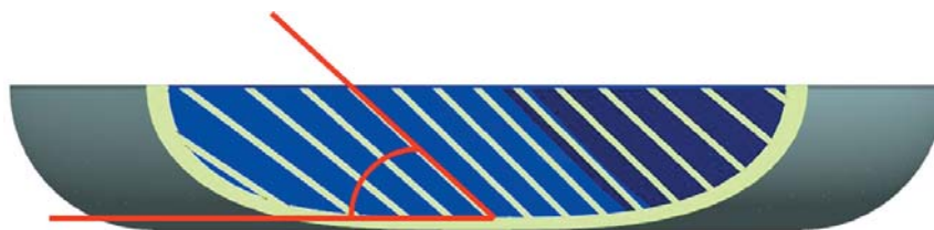
Рис. 7. Угол наклона лопаток в полости гидромуфты
