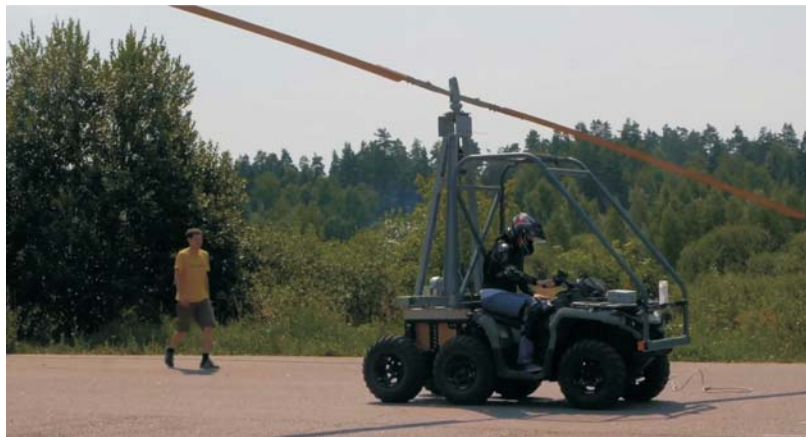
Рис. 2. Экспериментальные исследования тяговых характеристик авторотирующего НВ
