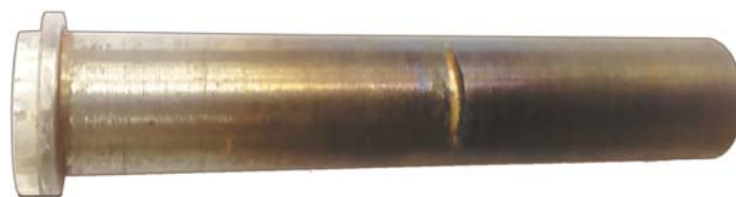
Рис. 8. Реальный образец оболочки с прямоугольным вырезом и помещенной внутрь тонкостенной капсулой для проведения натуральных экспериментов
