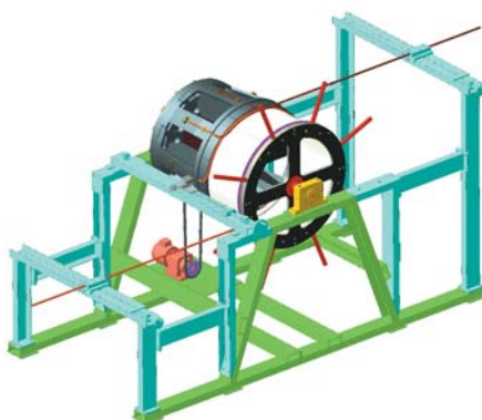
Рис. 4. Приспособление для изготовления модернизированных подвижных катушек вибростендов
