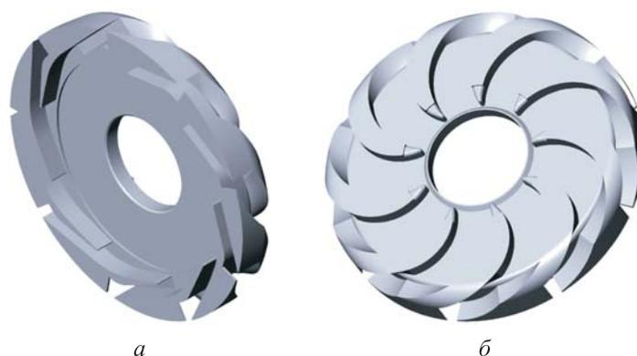
**Рис. 6.** Визуализация оптимизированного варианта НА канального типа:
