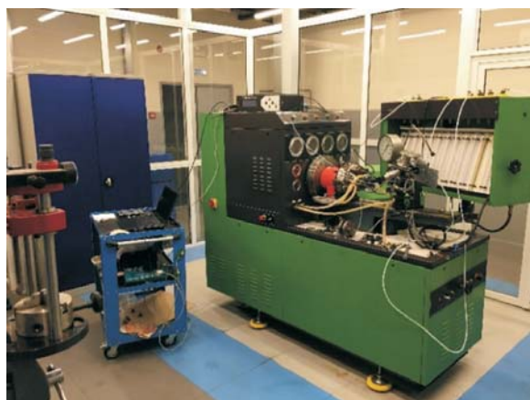
Рис. 1. Топливный испытательный стенд для измерения скорости звука
