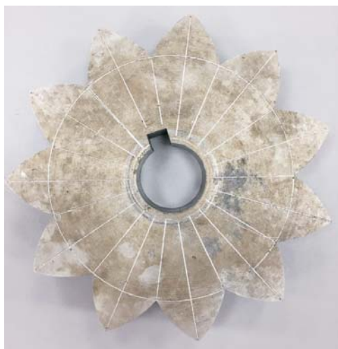
Рис. 2. Накатный ролик с радиальной сеткой
