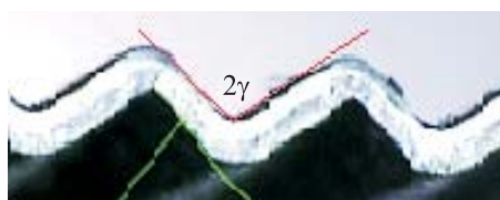
Рис. 9. Торцевая сторона накатанной ленты ( 2\gamma — угол профиля ленты)
