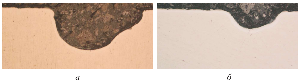
Рис. 5. Вид язв на поверхности сплава ВТИ-4 ( \times 200 ) после 30 циклов испытаний в среде \text{Na}_2\text{SO}_4 + \text{NaCl} при температурах 650 (а) и 700 °С (б)
