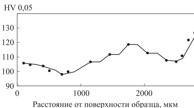
Рис. 8. Изменение микротвердости в поперечном ( Z ) сечении образца из сплава AlSi10Mg, полученного методом СЛС
