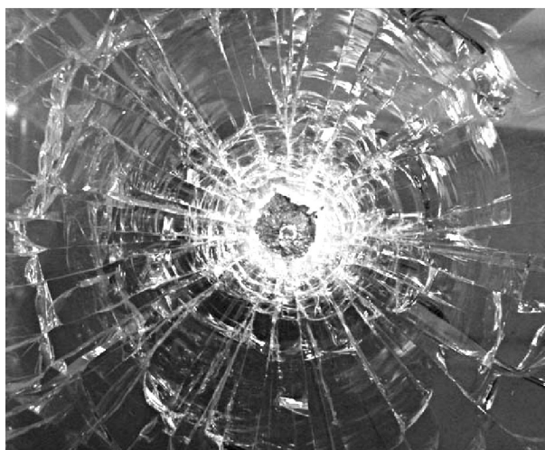
Рис. 1. Трехслойная прозрачная преграда после воздействия пули пистолета ПМ
