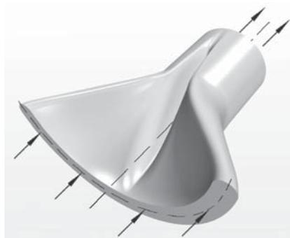
**Рис. 4.** Изометрическая проекция трехмерной модели проточной части нагнетательного канала
