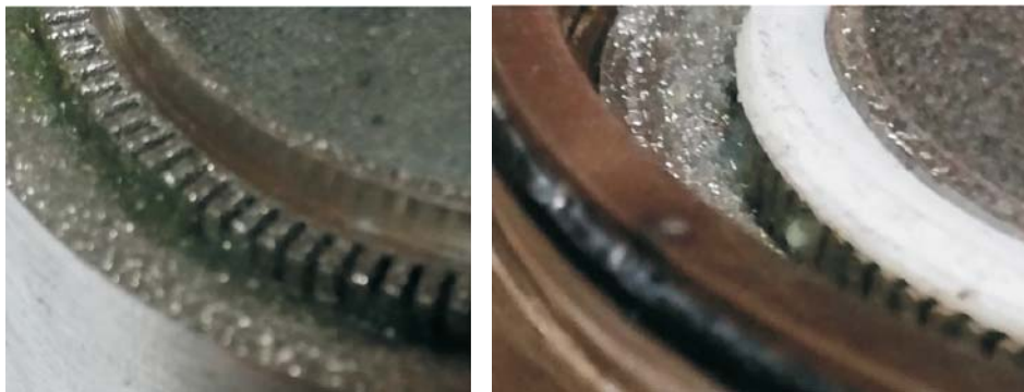
Рис. 4. Общий вид тракта охлаждения, изготовленного методом СЛП
