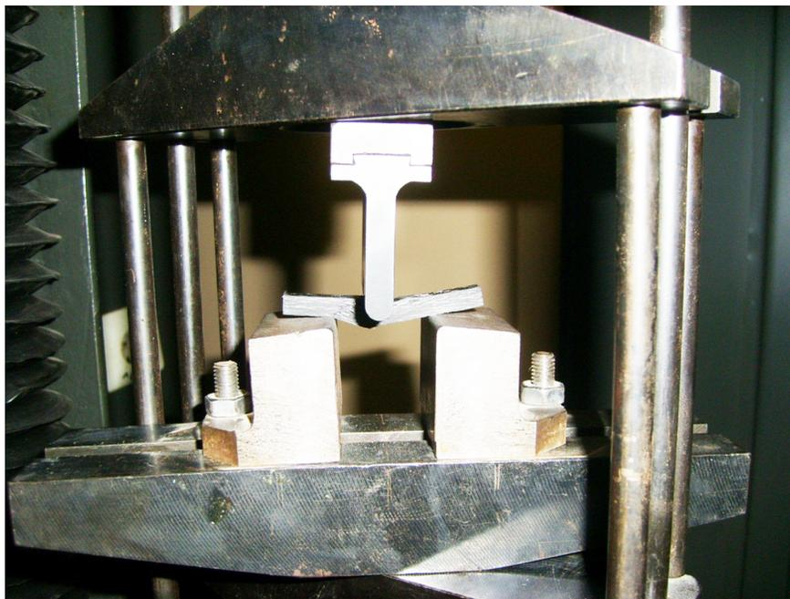
Рис. 5. Испытание образцов на сдвиг методом короткой балки
