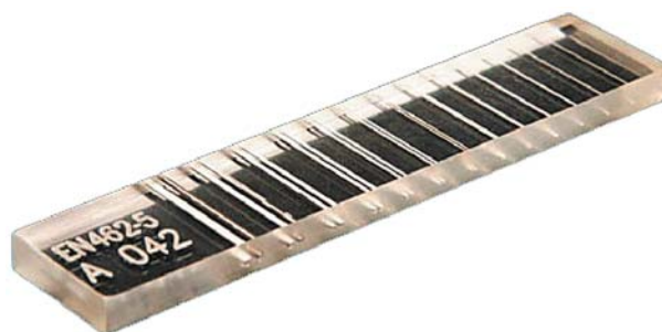
Рис. 1. Двухпроводочный (дуплексный) эталон IQI [7]
