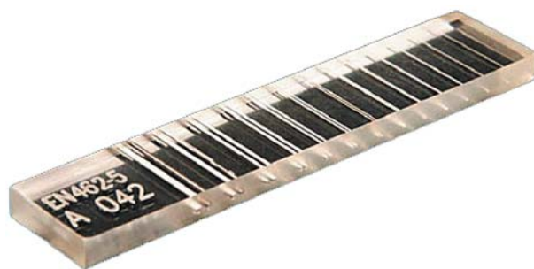
Рис. 1. Двухпроводочный (дуплексный) эталон IQI [7]
