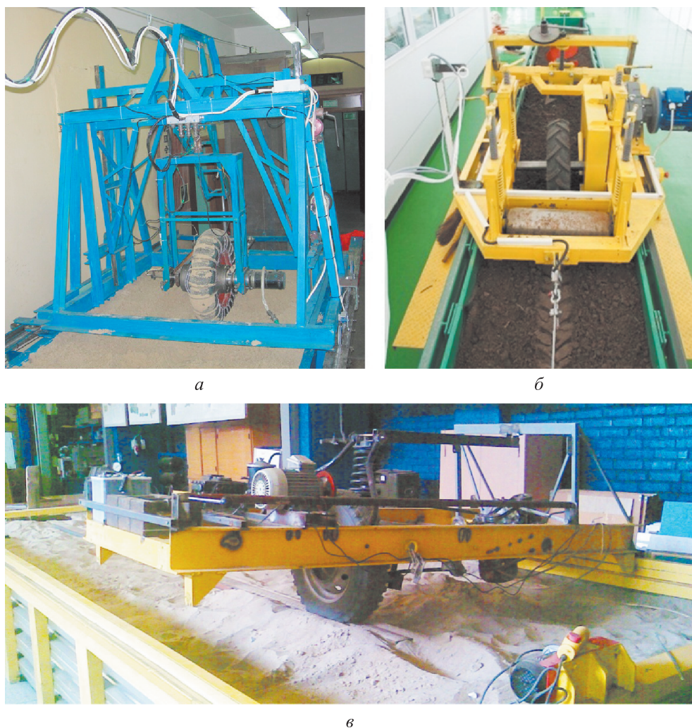
Рис. 2. Стенды для испытаний шин на деформируемых опорных поверхностях: а — «Грунтовой канал» МГТУ им. Н.Э. Баумана; б — «Soil bin» университета Гельмута Шмидта (Германия); в — «Активное колесо» МГИУ
