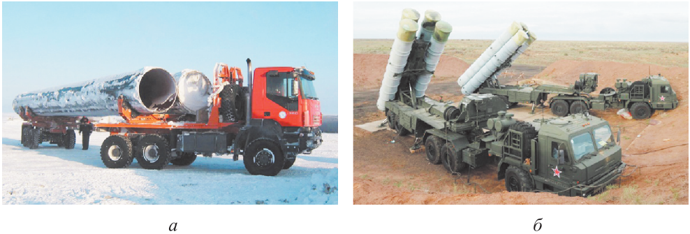
Рис. 1. Использование седельных автопоездов для перевозки грузов промышленного (а) и военного (б) назначения в условиях бездорожья
