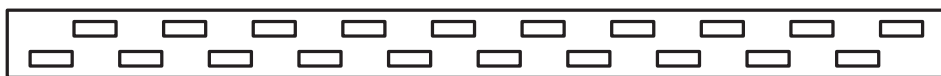
Рис. 5. Схема развертки кольцевой полосы радиатора с двухрядным размещением светодиодных матриц с шахматным смещением
