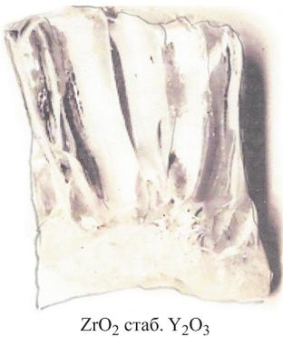
**Рис. 2.** Кристаллы фианита ( $ZrO_2-Y_2O_3$ )
