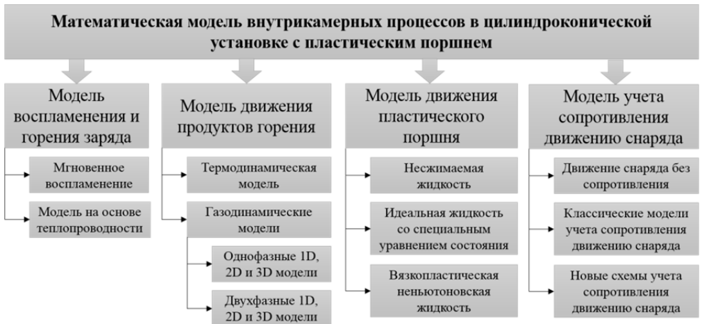
Рис. 2. Структура математических моделей внутрикамерных процессов в БУ с гидродинамическим эффектом
