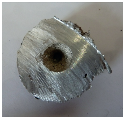
Рис. 6. Канал подачи кислорода в зоне частичного расплавления
