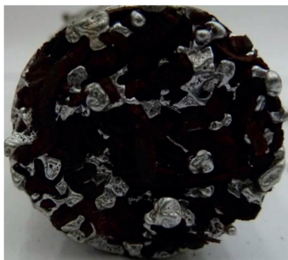
Рис. 3. Кристаллизация фронта горения расплава в канале вторичного окислителя
