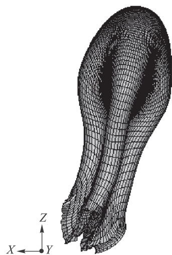
Рис. 7. Изгиб ВСЭ при наличии двух гармонических составляющих разностенности облицовки
