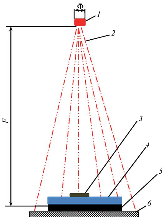
**Рис. 5. Схема эксперимента определения предела разрешения радиографической пленки:**
