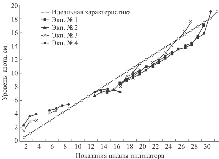
Рис. 9. Идеальная и наблюдаемая характеристики опытного и измерительного уровней
