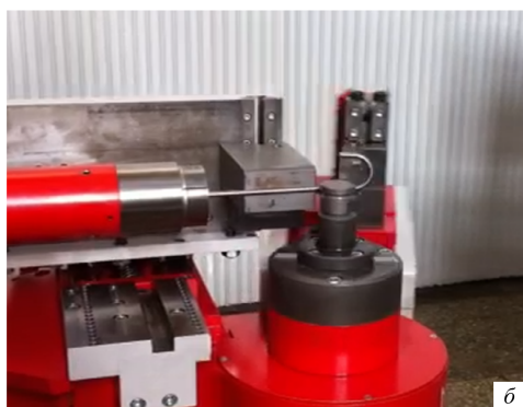
Рис. 11. Иллюстрация процесса гибки трубопровода двигательной установки: а – 3D-моделирование; б – изготовление
