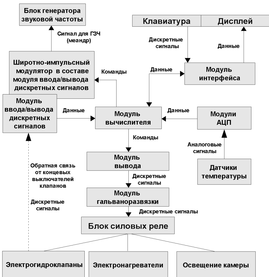
Рис. 3. Функциональная блок-схема ПДУ
