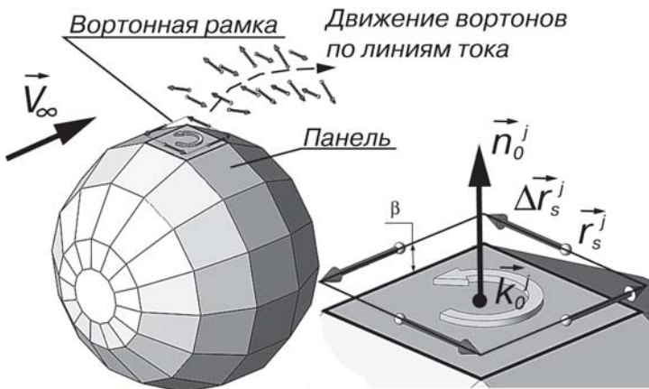
Рис. 2. Вихревые рамки на поверхности обтекаемого тела
