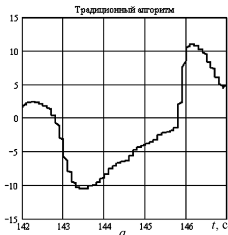
Рис. 5. Изменение управляющего момента M_y на участке разворота
