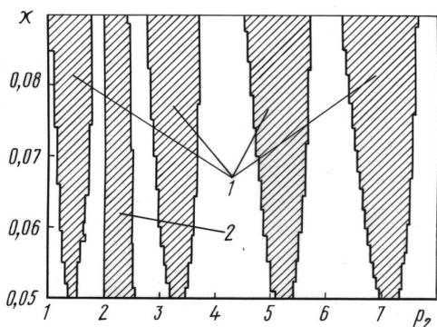
**Рис. 7. Зоны регулярного прерывистого резания на плоскости параметров  $\{\rho_2, \chi\}$**
