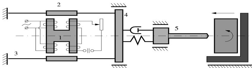
**Рис. 1.** Расчетная схема устройства для вибрационного сверления
