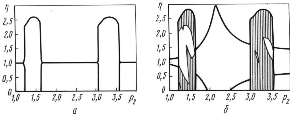
**Рис. 5.** Отображение Пуанкаре приведенной толщины снимаемого слоя для системы без возбуждения (а) и с возбуждением (б) вибраций инструмента; изменяемый параметр  $p_2$
