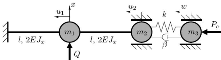
Рис. 3. Расчетная схема механической составляющей системы
