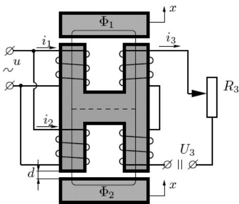
**Рис. 2.** Расчетная схема вибровозбудителя
