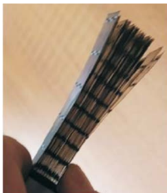
Рис. 1. Теплопередающий пакет роторного теплообменника
