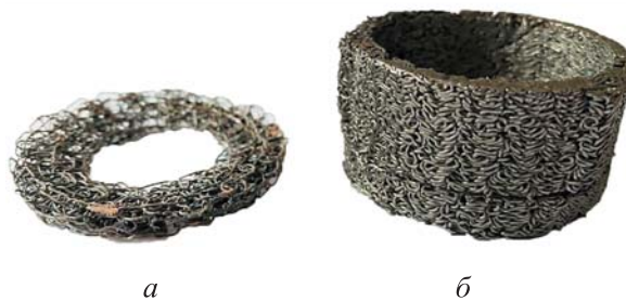
Рис. 3. Фильтрующий элемент дискового (а) и цилиндрического (б) типов из ППМ
