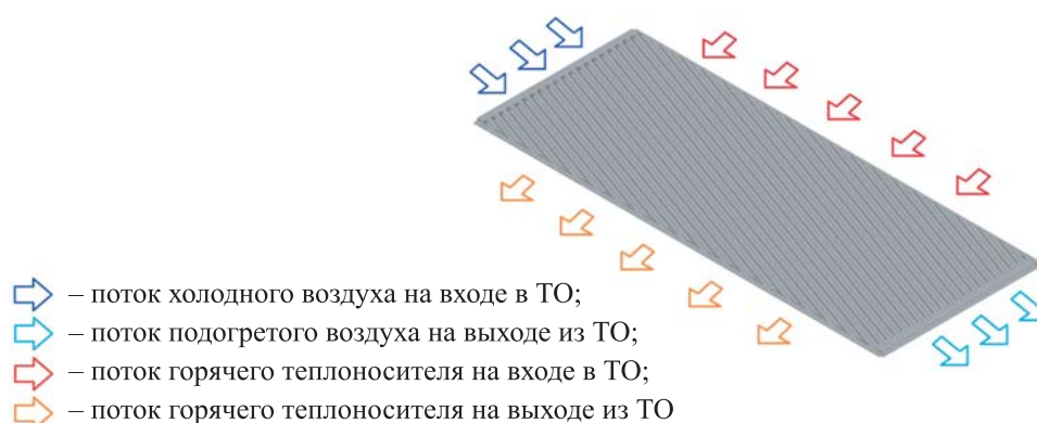
Рис. 2. Расчетная модель конверта матрицы модуля пластинчатого ТО
