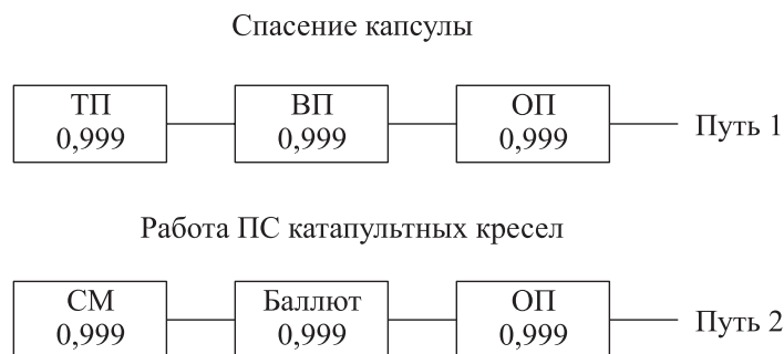
Рис. 1. Расчетная схема для ПС КСА «Близнецы» (ТП, ВП, ОП — тормозной, вытяжной и основной парашюты; СМ — стреляющий механизм)
