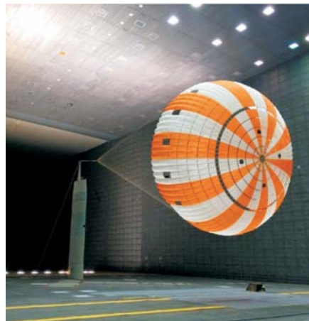
Рис. 5. Продувка ОП КСА «Орион» в аэродинамической трубе
