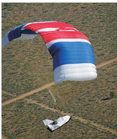
Рис. 9. Аппарат — прототип X-38 при приземлении на поврежденном рекордном планирующем парашюте-крыле
