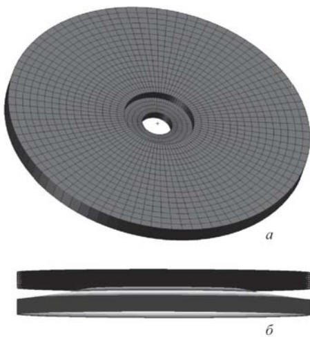
Рис. 6. Точная геометрия модели рабочего диска (а) и модель его изгиба (б) под действием центробежных сил при высоких частотах вращения
