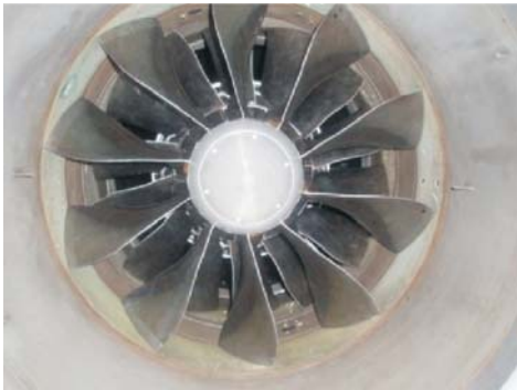
Рис. 1. Биротативный вентилятор CRTF2A
