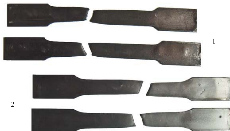
Рис. 3. Образцы после испытаний: 1 — сталь марки 20; 2 — сталь S235JRG2
