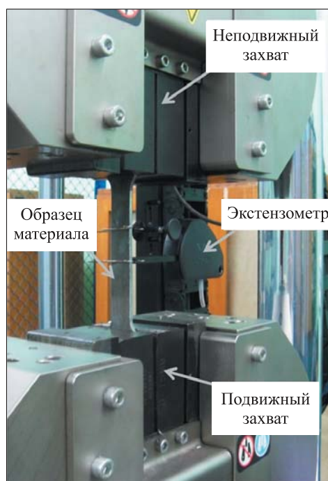
Рис. 2. Процесс испытаний образца материала — сталь марки 20 (приложение нагрузки, измерение деформаций)
