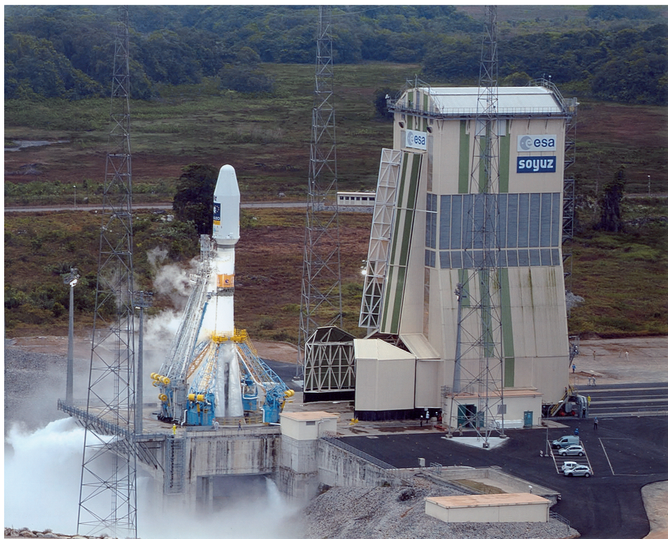
Рис. 5. Стартовый комплекс ракеты “Союз-СТ” при выполнении операций заправки криогенными продуктами
